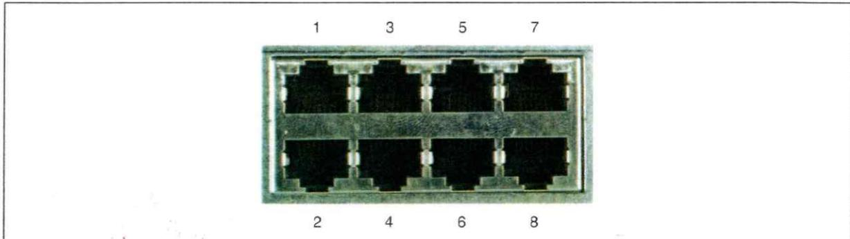
Abbildung 4: AK810 Ethernet Schnittstellen
